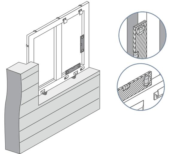
**7 Механическое крепление конструкции с помощью анкерных пластин/саморезов**
