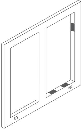
**4 Установка анкерных пластины/саморезов**
